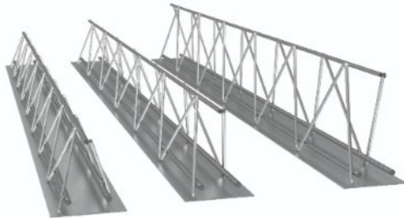
Fue diseñada y calculada para trabajar como elemento o nervadura de carga en techos o entrepisos de concreto aligerado. Al ser colada junto con la losa de compresión forma una viga de sección compuesta con mejor resistencia.
