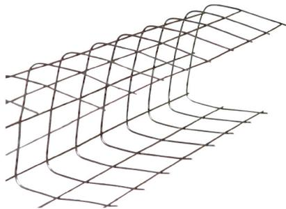
Las mallas en “U” para boquilla recubren el poliestireno del panel que se ha cortado para los vanos de las puertas o ventanas. Se colocan en todo el contorno del vano, dejando una separación de 2 cm del poliestireno para ser rellenado con el mortero y formar la boquilla donde se fijarán las ventanas o puertas.
