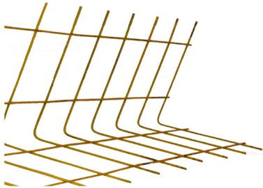
La malla en "L" se coloca en las esquinas de los muros por ambos lados (interior y exterior) reforzando la unión en esquina de un panel con otro. También se coloca en la unión del muro de panel y techo, a todo lo largo del perímetro interior.
